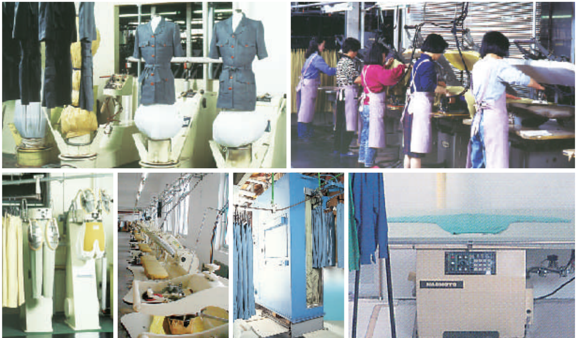
上段左より:シセル人体プレス機、ホフマンプレス機 下段左より:シセルパンツトッパー、ホフマンプレス機、トンネルフィニッシャー、平面吹き上げ(セーター仕上げ機)
