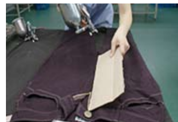
インキング補修
